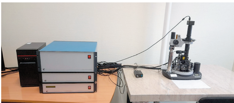
Рис. 1. Общий вид атомно-силового микроскопа «Интегра Прима» (ООО «НТ-МДТ», Россия) в рабочей обстановке в учебно-научной лаборатории кафедры лабораторной медицины с клиникой лечебного факультета Института медицинского образования НМИЦ им. В. А. Алмазова (собственное фото авторов)
